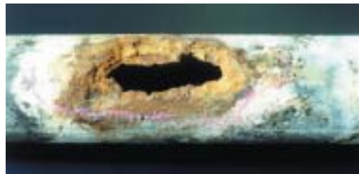
コンクリート/土壌マクロセル腐食例
